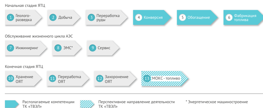
Рис. 1. Место ТК «ТВЭЛ» в ядерном топливном цикле
